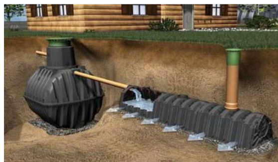
jímka pro využití srážkové vody s přepadem do vsakovacího objektu
